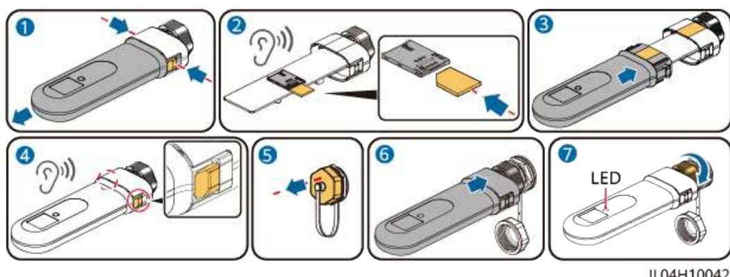
**Figura 5-37** Instalación de componentes antirrobo para el Smart Dongle
