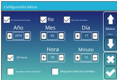
**Restablecimiento de fábrica:** Restablecer todos los parámetros del inversor. **Bloquear todos los cambios:** Habilite este menú para configurar parámetros que requieren bloqueo y que no se pueden configurar. Antes de realizar un restablecimiento de fábrica y bloquear los sistemas, para conservar todos los cambios, debe introducir una contraseña para habilitar la configuración. La contraseña para la configuración de fábrica es 9999 y para el bloqueo es 7777.
