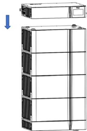
4. Finalmente, instale la caja de alto voltaje en la capa superior del módulo de la batería.
