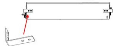
5 Utilice tornillos hexagonales M4\*12 para instalar la placa de fijación de la caja entre la base y el módulo de la batería, entre los módulos de la batería, y también entre el módulo de la batería y la caja de alto voltaje.
